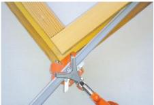
Fase 2 Le pinze Q-Lon vengono posizionate nell'angolo di battuta con l'arresto e viene effettuato un taglio obliquo a 90°.
