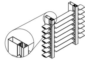
D3 - Per sottostruttura. Angoli prestabiliti e variabili.
