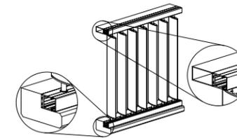
D6 - Collegabile frontalmente e lateralmente alla muratura e alle sottostrutture in acciaio. Angoli prestabiliti e variabili.
