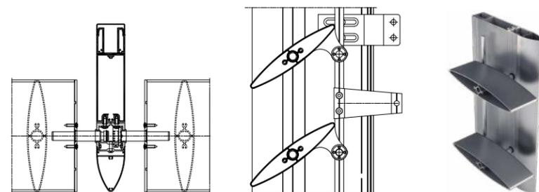
Larghezze lamelle in alluminio estruso di sezione ellittica
