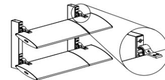
D5 - Per sottostruttura. Angoli prestabiliti, lamella continua.
