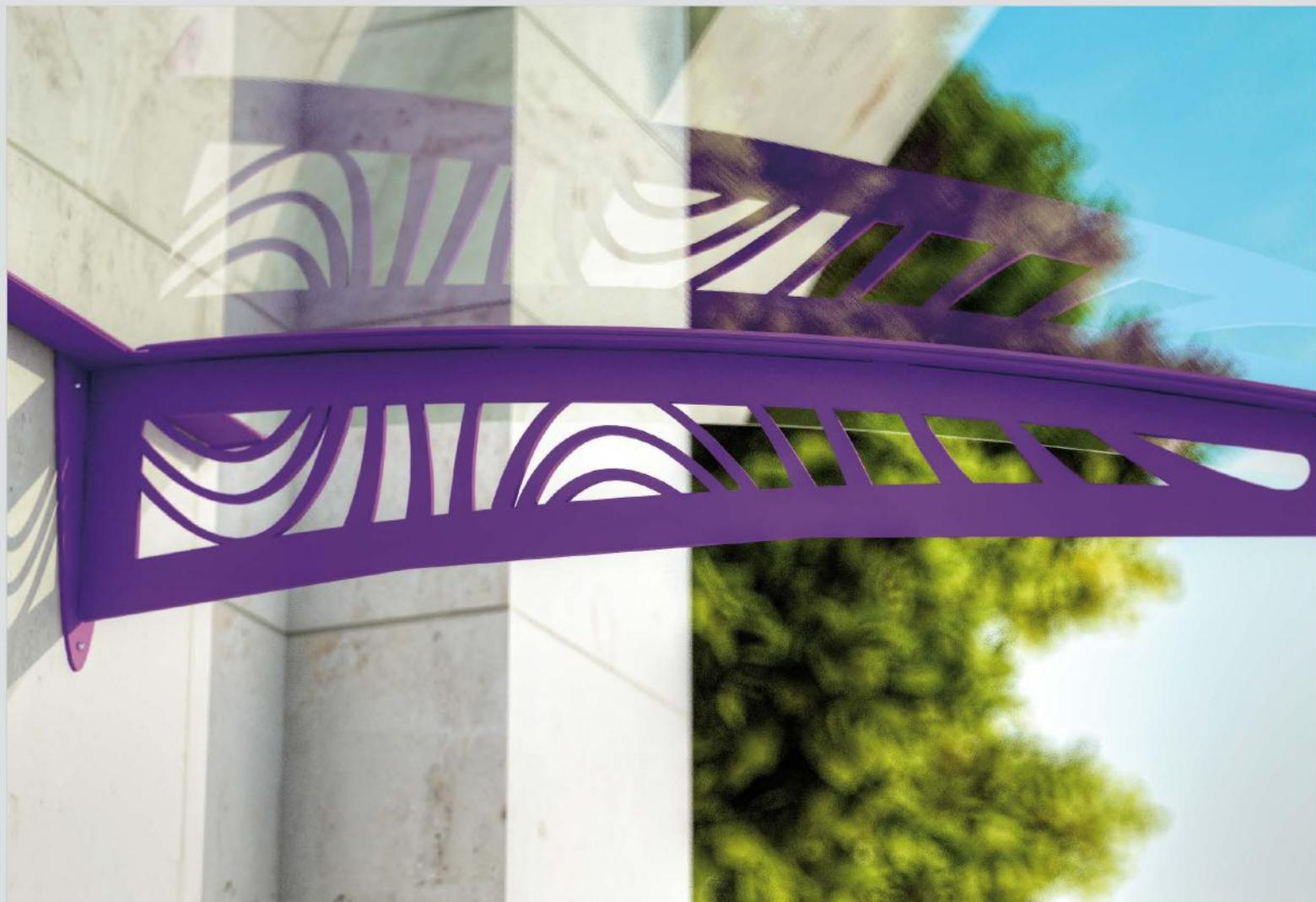
Bracci in acciaio zincato e verniciato come da ns. cartella colori, sp.4 mm con adeguate alette per il deflusso delle acque, con avente misura di sporgenza di 750/1000/1250/1500 mm. possibilità' di aumentare la larghezza del prodotto con misure multiple di quelle standard (vedi ns. listino).
