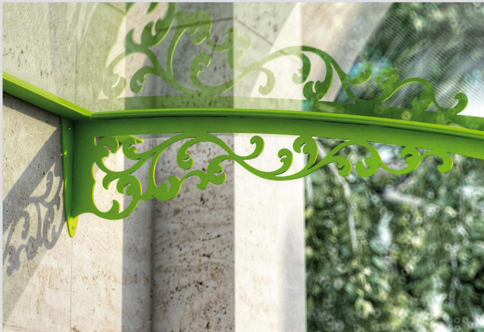
Bracci in acciaio zincato e verniciato come da ns. cartella colori, sp.4 mm con adeguate alette per il deflusso delle acque, con avente misura di sporgenza di 750/1000/1250/1500 mm. possibilita' di aumentare la larghezza del prodotto con misure multiple di quelle standard (vedi ns. listino).
