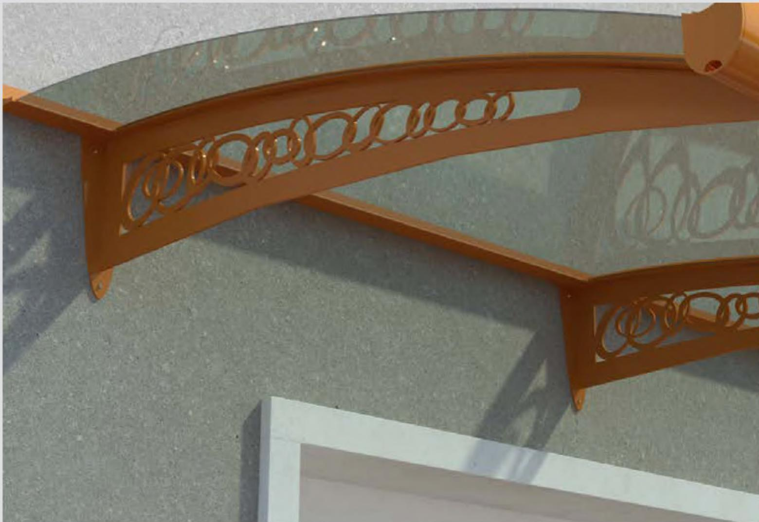
Bracci in acciaio zincato e verniciato come da ns. cartella colori, sp.4 mm con adeguate alette per il deflusso delle acque, con avente misura di sporgenza di 750/1000/1250/1500 mm. possibilita' di aumentare la larghezza del prodotto con misure multiple di quelle standard (vedi ns. listino).
